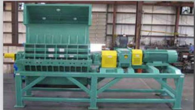
El SATURN GRIZZLY™ SUPER 80 (S-80) de Granutech-Saturn Sytems es la nueva generación de triturador secundario de alto desempeño. El S-80 proporciona el más alto rendimiento en una sola máquina para el reciclaje de llantas con una capacidad de hasta 10 toneladas por hora.
