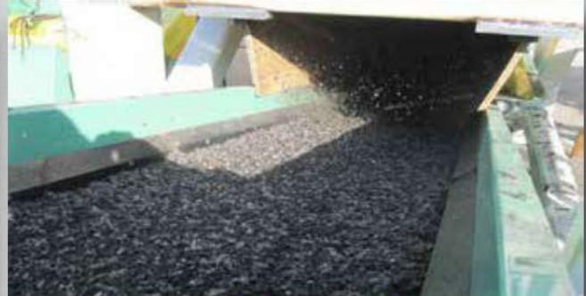
Por cerca de dos décadas, el SATURN GRIZZLY™ Modelo 80 (M-80) ha sobresalido en la reducción de fragmentos de llanta a trocitos virtualmente libres de acero. El enorme rotor, diseño de cuchillas de bajo costo, y las cribas reemplazables proveen un proceso de operación altamente confiable y eficiente. Debido al diseño de las cuchillas, el producto del Grizzly M-80 es ideal para áreas de juego y diseño de jardines.
